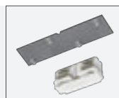
Connecteur longitudinal avec stabilisateur 16 A max. | polycarbonate (PC) / acier L : 6,2 cm l : 2,5 cm H : 2,7 cm
